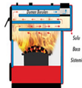
Atmosfere yikan boga gazı uezakligindon maksimum ızydoyı saqlayan 4 pozıylı ve sulubozalı sistem
